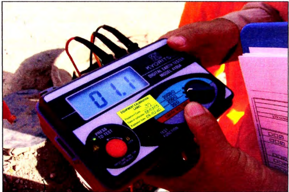
Figura 3.8 - Telurómetro KYORITSU con su control de calibración (Fuente: Foto tomada en Octubre 2009)
