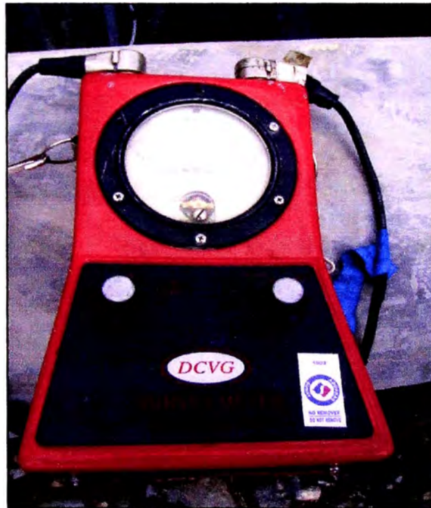
Figura 4.9 – Equipo medidor de Gradiente de voltaje DC (DCVG) (Fuente: Foto tomada en Mayo 2010)
