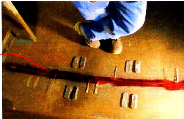
**Figura 5.41.:** Ensayo de tintes penetrantes.
