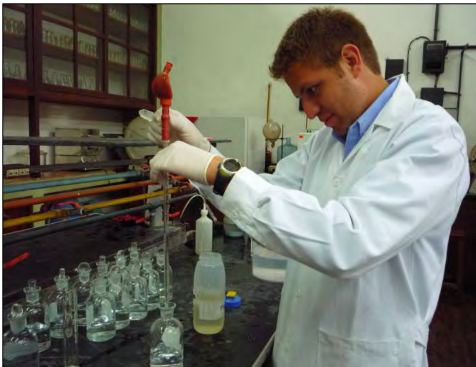
Fotografía N° 11.2 Preparación de Diluciones para la Determinación de la Demanda Bioquímica de Oxígeno
