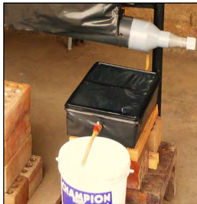
Fotografía N° 5.45: Sedimentador envuelto en plástico
