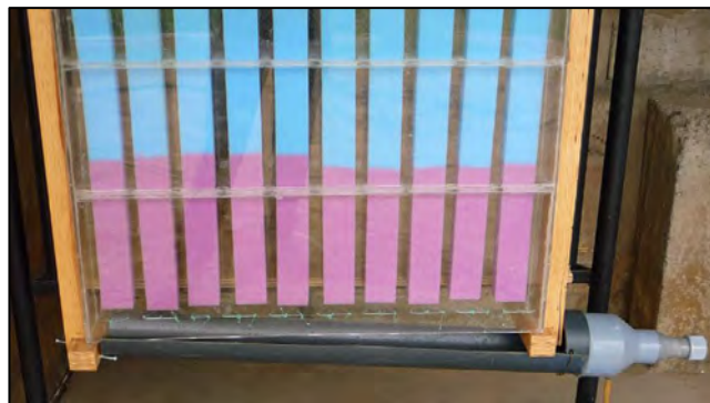
Fotografía N° 5.8: Sistema Recolector de Caudal
