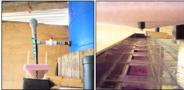
Fotografía N° 5.39: Vista Lateral del Sistema Distribuidor de Caudal
