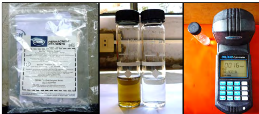
Fotografía N° 5.23: Reactivo Nitriver, Celdas Hach de 25ml y Colorímetro Hach DR/890
