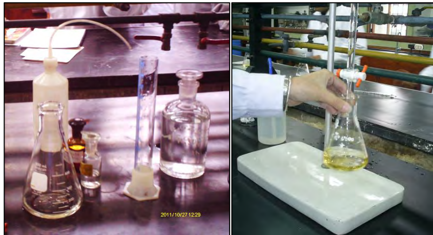
Fotografía N° 5.25: Matraz y Probeta de vidrio, Reactivo Ácido Sulfúrico e Indicadores Fenolftaleína y Anaranjado de Metilo
