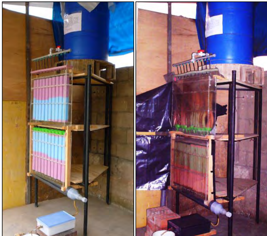
Fotografía N° 6.1: Vista Lateral de la Formación de Biomasa en el Sistema DHS
