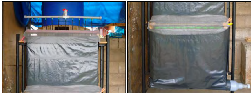
Fotografía N° 5.43: Reactor R1 y R2 envueltos en plástico
