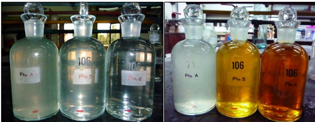
Fotografía N° 11.4 Determinación del Oxígeno Disuelto en los Puntos de muestreo A, B y C mediante el Método de Winkler
