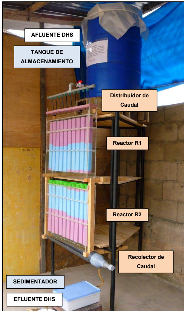
Fotografía N° 5.2: Vista general del sistema DHS tipo bloques prismáticos a escala piloto
