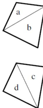
Figura 3-2. Elementos cuadriláteros superpuestos usados en FLAC. (ITASCA, 2011)
