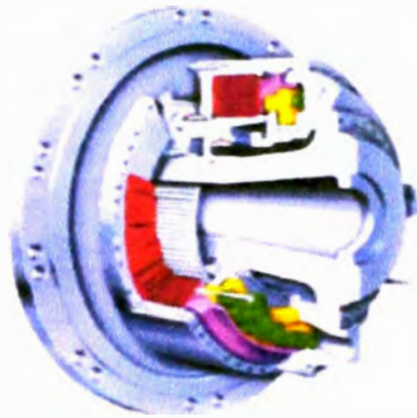
Figura 9.1: Esquema del freno en el camión 777F
