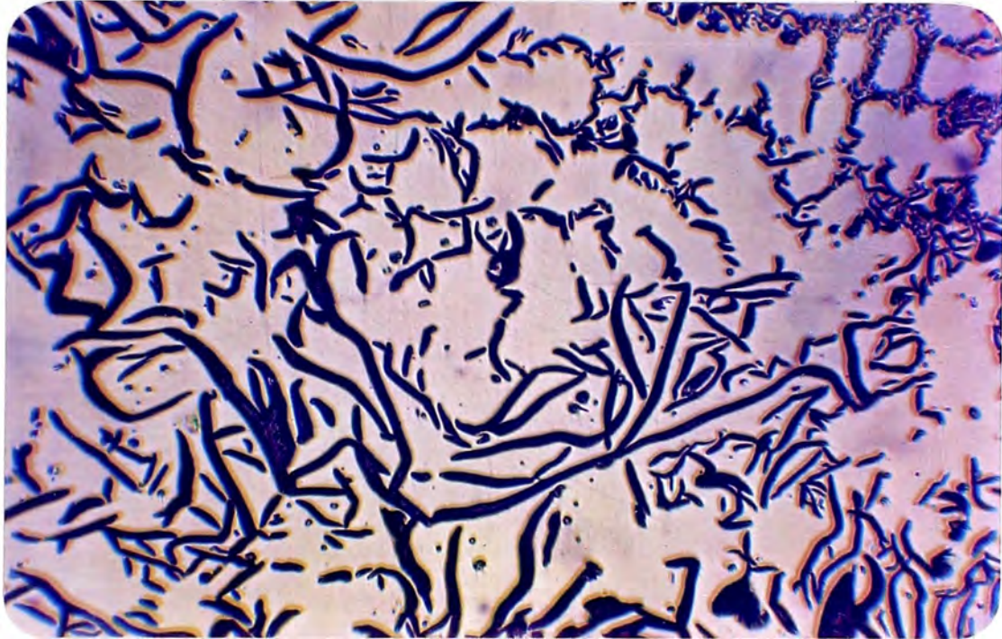
Fig. 23 a.- Microestructura de un hierro gris sin inocular . Sin ataque , X 100 .
