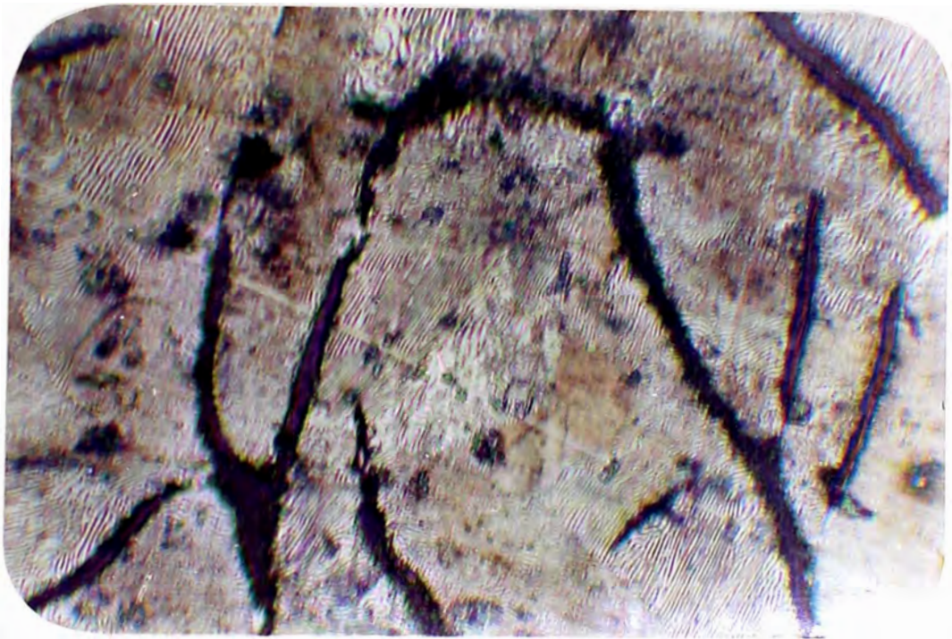
Fig. 14-2.- Microestructura de un tambor de freno segunda parte, atacado, Nital 2% X 500 .
