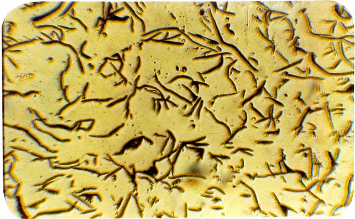
Fig. 18 a.- Microestructura de un hierro gris, inocul. con I-25/Cu , 0.350/0.625 . Sin ataque X100.
