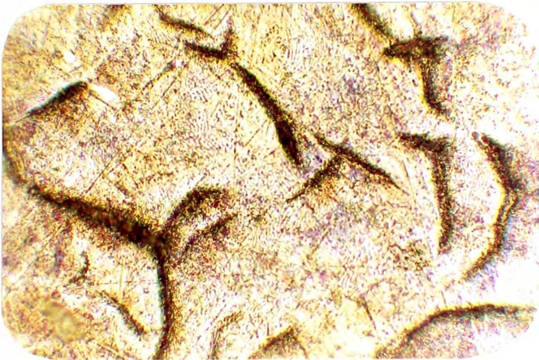
Fig. 22 b.- Microestructura de un hierro gris sin inocular . atacado con Nital 2% X 500 .
