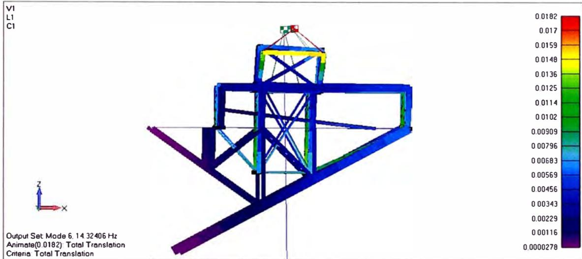
Ilustración 4-26: Vista lateral del sexto modo de vibración
