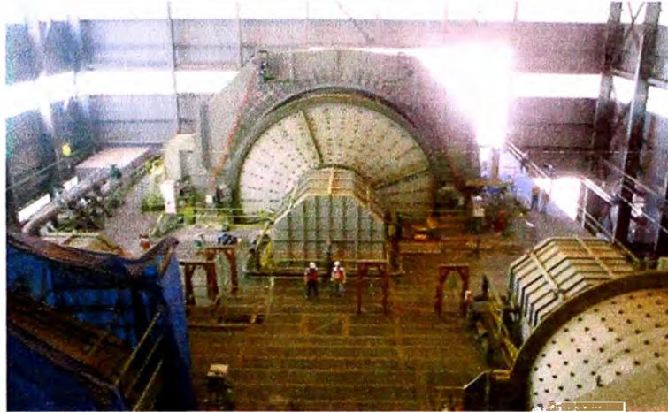
**Fig. 2.3 Molino de Bolas en operación, Planta Minera Antamina.**
