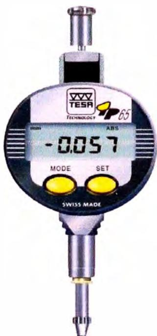
**Fig. 4.19 Digital apreciación 0,001 mm rango 1 mm, (Curso de Instrumentos de medición, Carlos Miño).**
