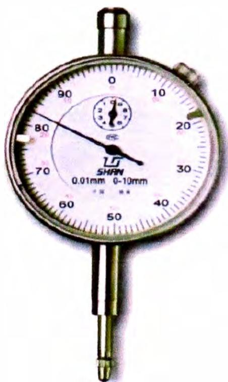
**Fig. 4.17 Mecánico cuadrante completo apreciación 0,01 mm rango 10 mm, (Curso de Instrumentos de medición, Carlos Miño).**
