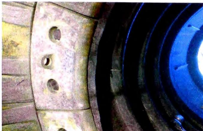
**Fig. 5.139 Montaje de corazas tipo plate, (Proyecto Antapaccay).**
