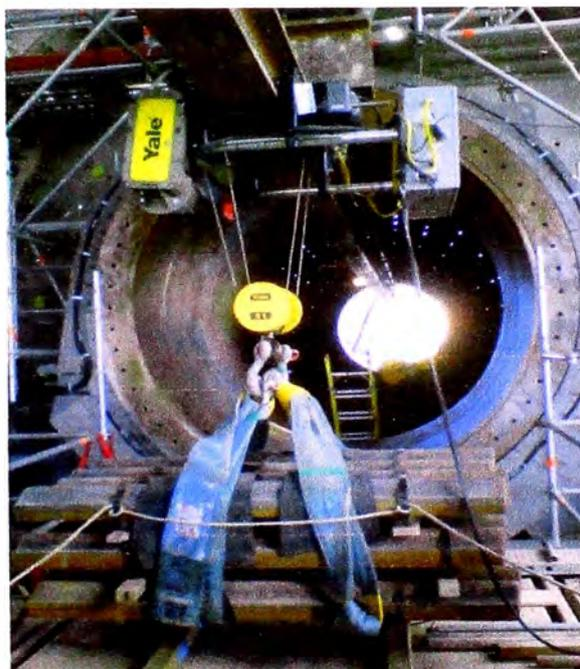
**Fig. 5.118 Prueba de carga, (Proyecto Antapaccay).**
