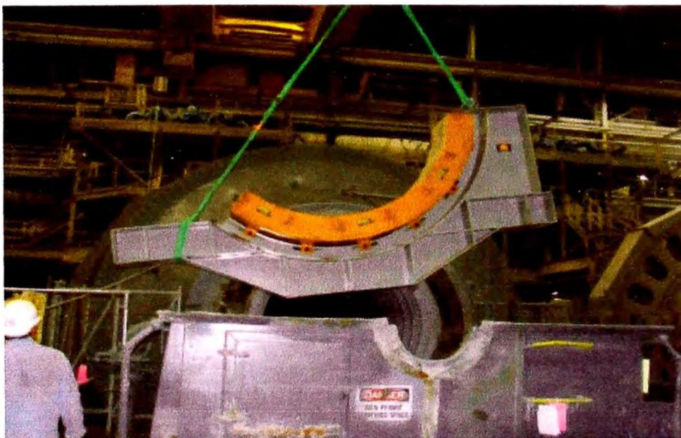
**Fig. 5.140 Montaje soporte de magneto (Trunnion Magnet System).**
