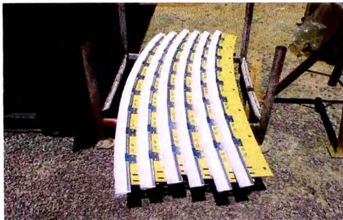
**Fig. 5.229** Cepillos para proteger del polvo el interior del estator, (Proyecto Antapaccay).
