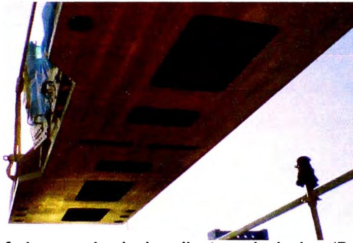
**Fig. 5.44 Superficie inferior maquinada de cojinetes principales, (Proyecto Antapaccay).**
