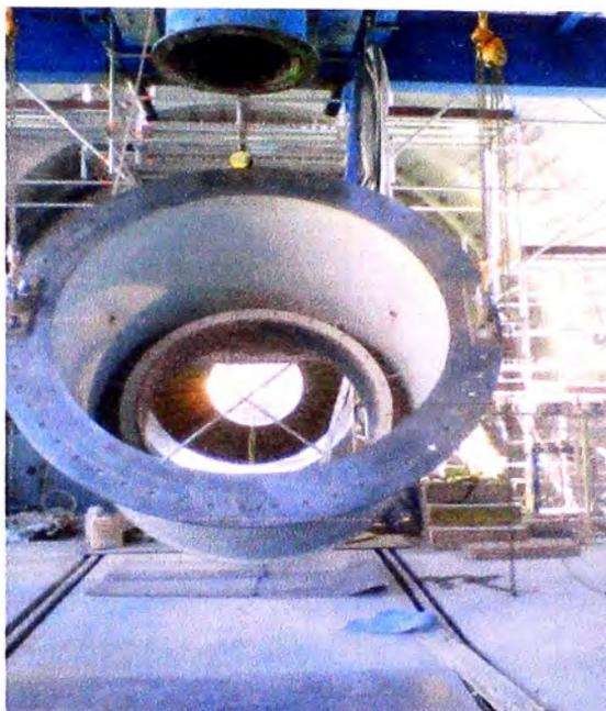
**Fig. 5.129 Tandem de trunnion liner de alimentación, (Proyecto Antapaccay).**
