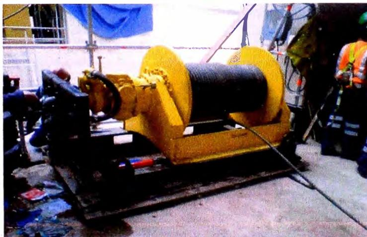
**Fig. 5.92 Instalación de cabestrante, (Proyecto Antapaccay).**
