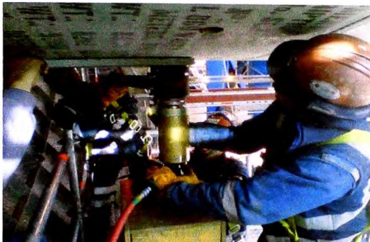
Fig. 5.125 Torque de pernos en corazas, (Proyecto Antapaccay).
