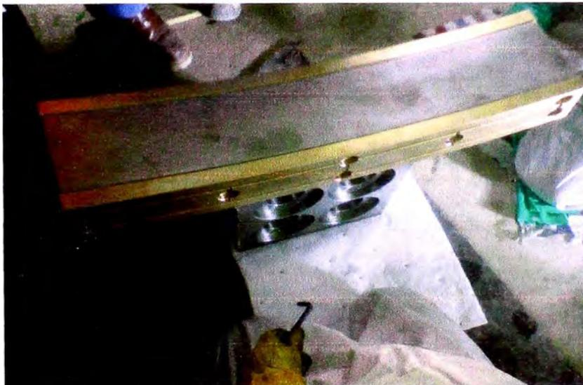
**Fig. 5.41 Limpieza de rieles de empuje (Thrust Pads), (Proyecto Antapaccay).**
