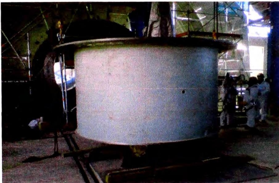
**Fig. 5.128 Izaje con 2 tecles del trunnion liner de alimentación, (Proyecto Antapaccay).**
