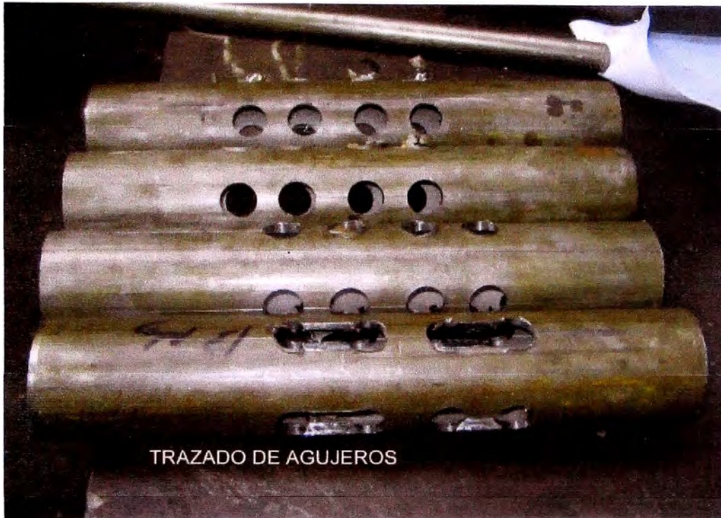
Figura 4.5 Sector a reemplazar - Proceso del trazado de agujeros Zona de admisión de aire del aje
