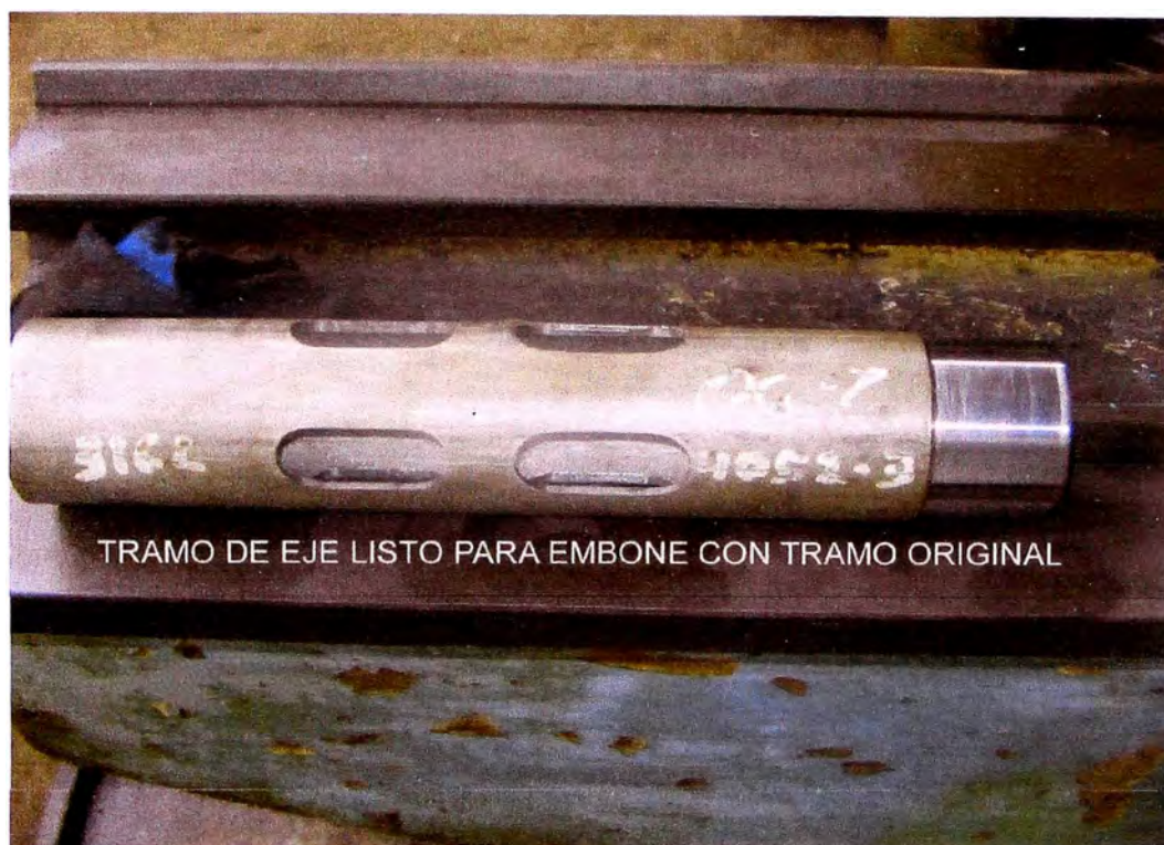
Figura 4.7. Tramo de eje listo para embone con tramo original zona de admisión
