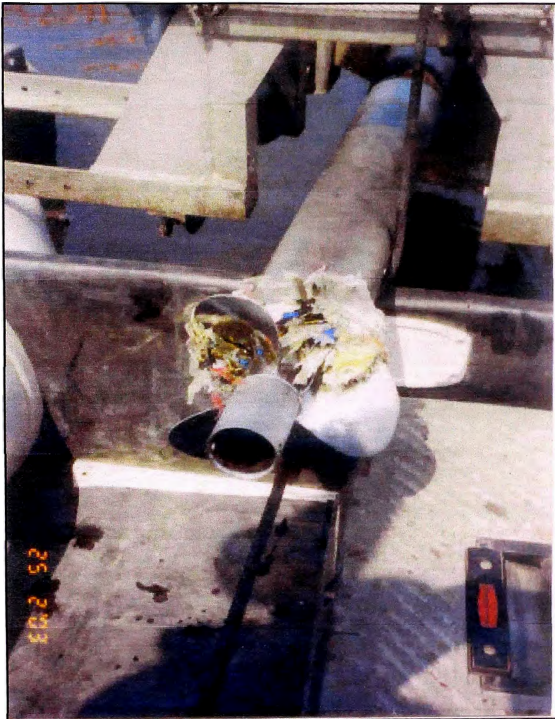
FIG 4.3 Eje trabado por sólidos inorgánicos
