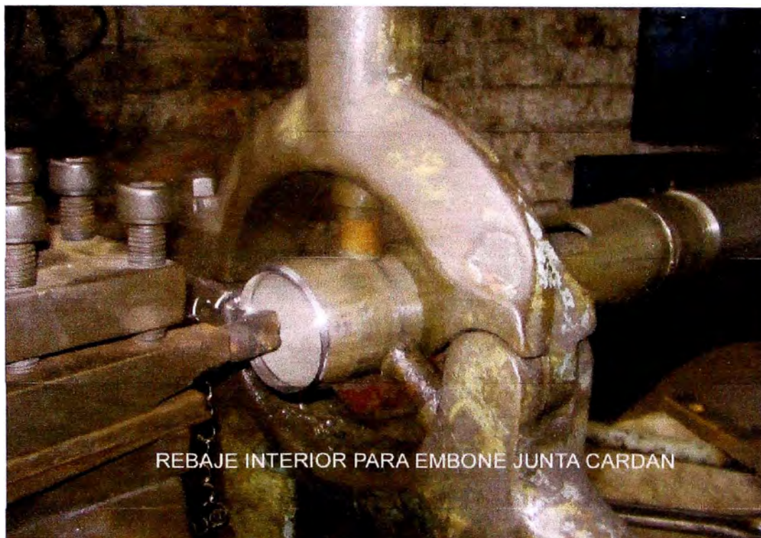
Figura 4.11. Rebaje interior para embone y soldado de junta cardán
