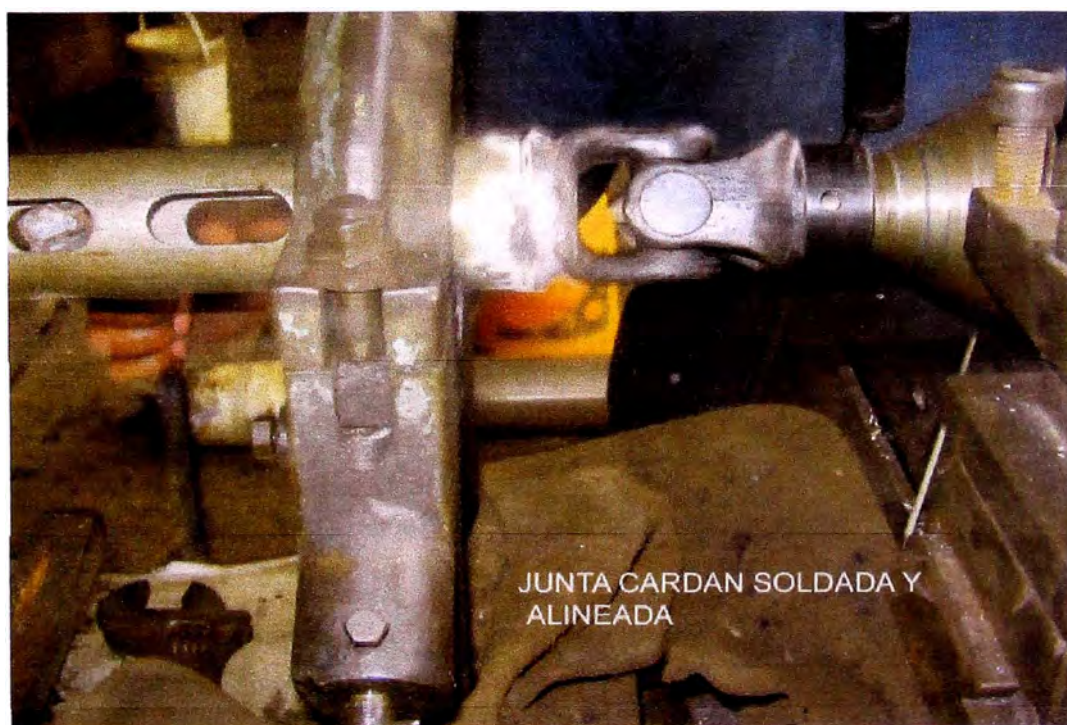
Figura 4.11. Rebaje interior para embone y soldado de junta cardán
