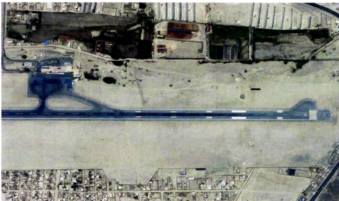
Figura 3.4 Pista de aterrizaje, calle de rodaje y plataforma de un aeropuerto
