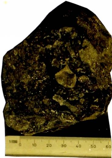
a) Textura brechada: Fragmento de roca alterada en una matriz mineralizada
