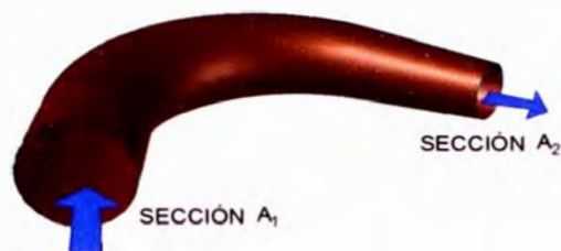
FIGURA N° 2.15: Esquema de una tubería de sección variable
