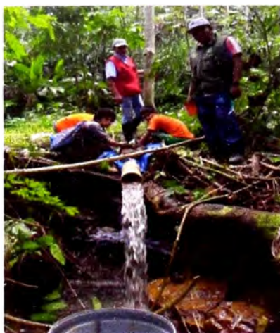
FOTOGRAFÍA N° 3.3: Aforamiento de la Quebrada Matereni – Setiembre 2016
