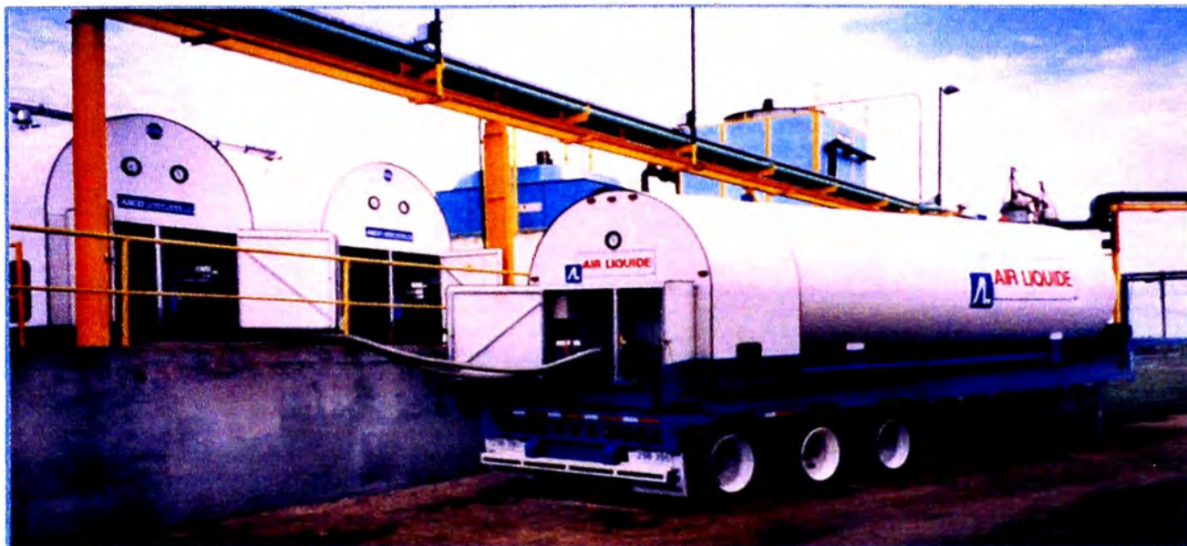
Figura 3.4: Tanque cisterna en proceso de descarga de dióxido de carbono Fuente: www.Airliquide.com , Martes 12/06/2012 12:00 m
