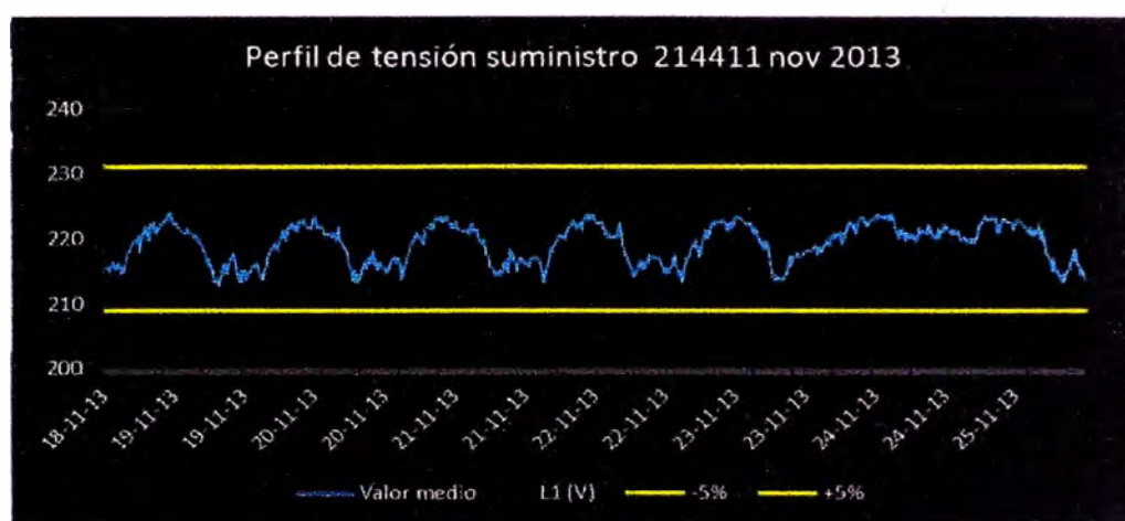
Figura N° 6.6: Perfil de tensión del suministro N° 214411 en noviembre 2013
