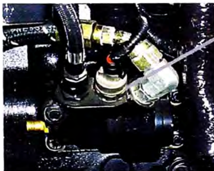
Foto 3.8. Sensor primario de la presión del Gas al ingreso al motor
