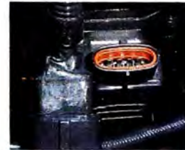
Foto 3.7. Sensor del flujo de Gas al interior del mezclador
