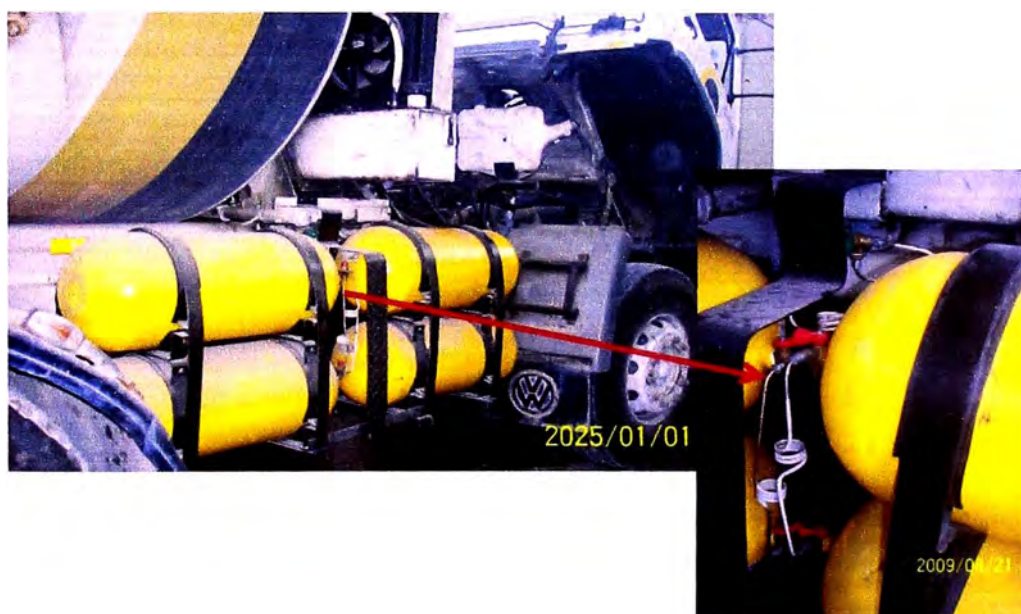
Foto 3.24. Instalación de las válvulas manuales de los tanques
