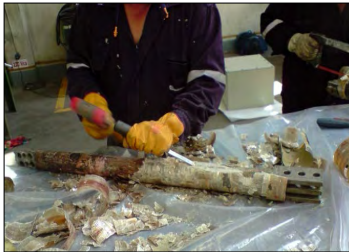
Figura 6. 19: Retirando el aislamiento envolvente de la barra
