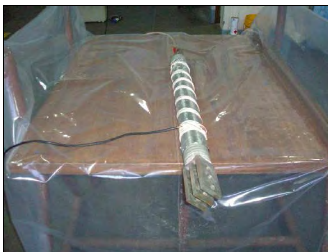
Figura 6. 29: Prueba de tensión aplicada a las barras reparadas
