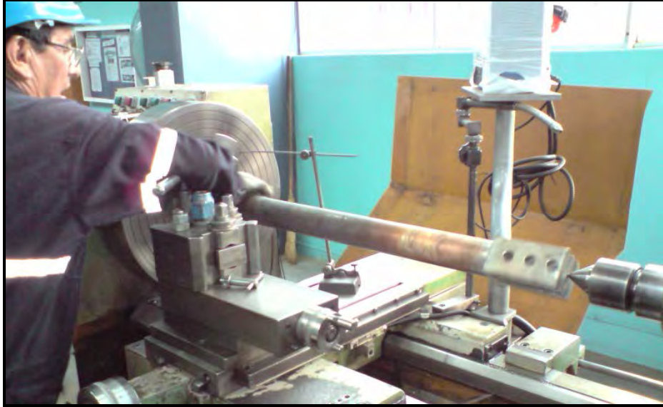
Figura 6. 25: Torneando la barra reparada
