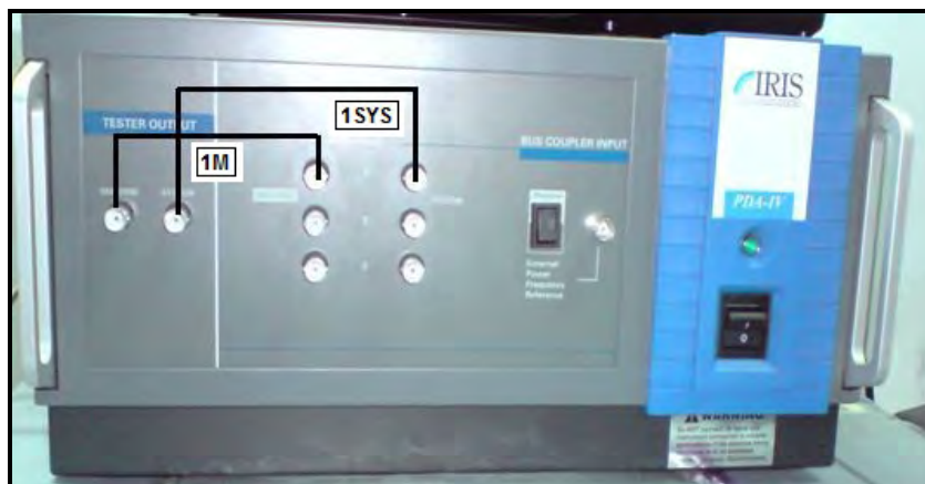
Figura 4. 33: Conexionado para prueba de operatividad
