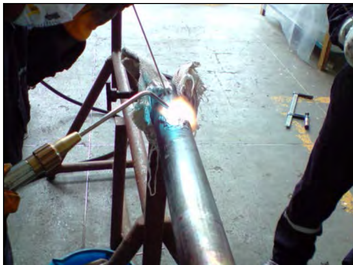
Figura 6. 24: Perforación de barra rellanado con silfos
