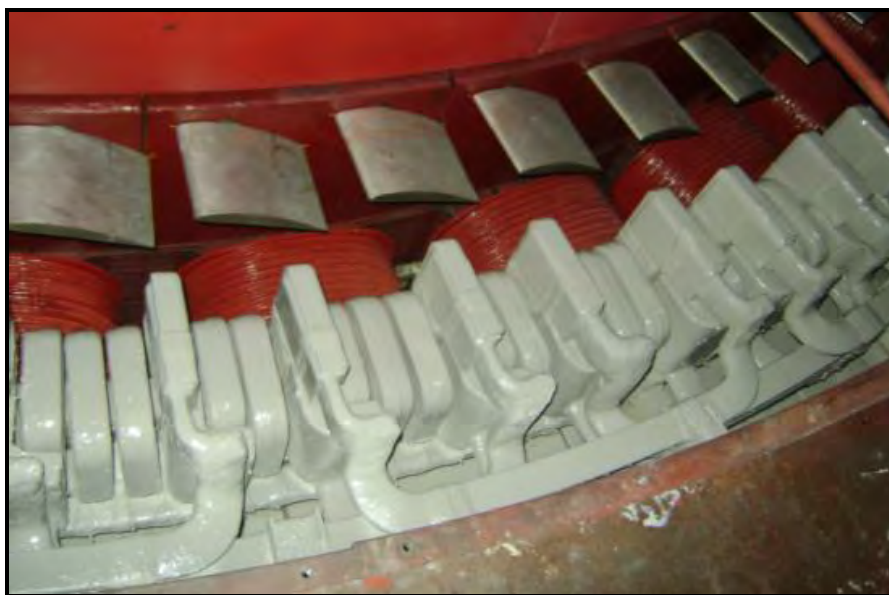
Figura 6. 55: Vista superior del estator – período de secado
