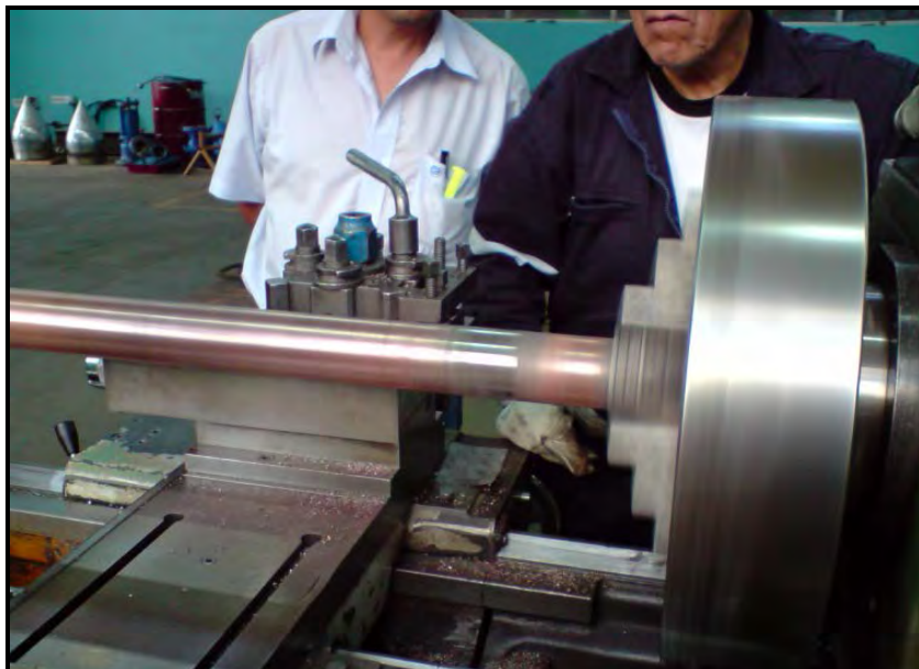
Figura 6. 26: Torneado finalizado de la barra reparada
