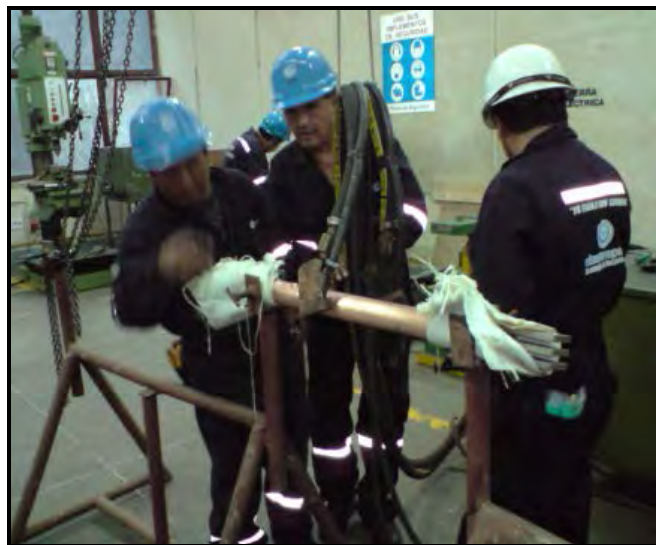
Figura 6. 22: Fijación de la barra a soldar en los caballetes
