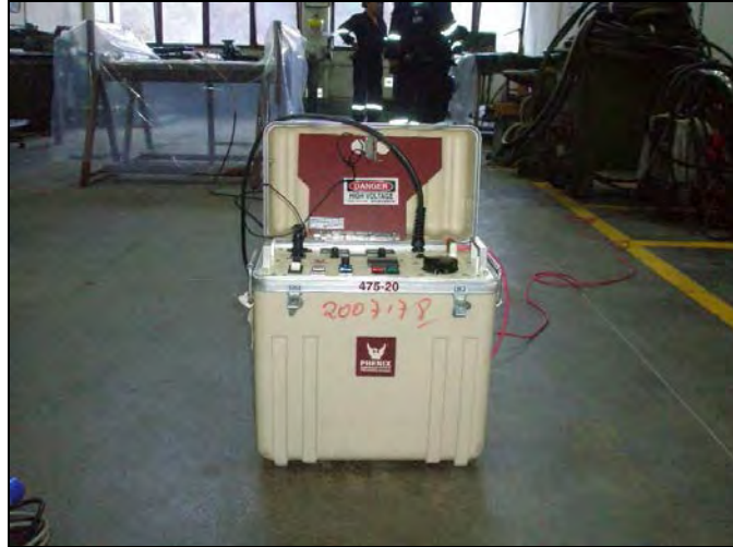
Figura 6. 30: Equipo Phenix para prueba de tensión aplicada
