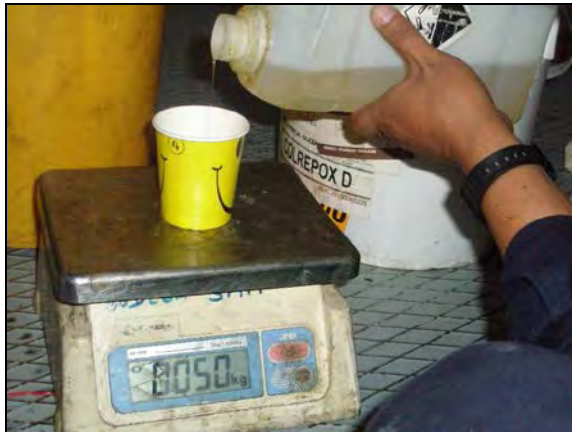
Figura: 6. 27: Mezcla de resina y endurecedor para realizar el reaislamiento
