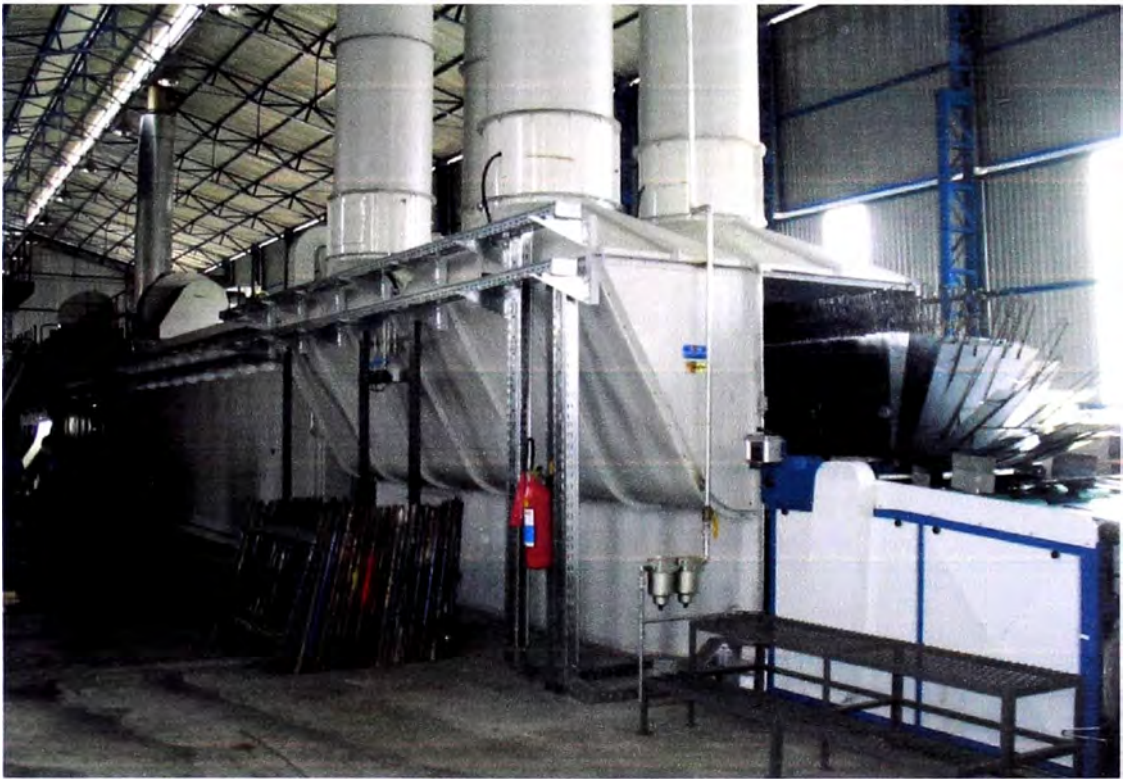
Fig. 2 - Horno de Barnizado: Zona de Ingreso
