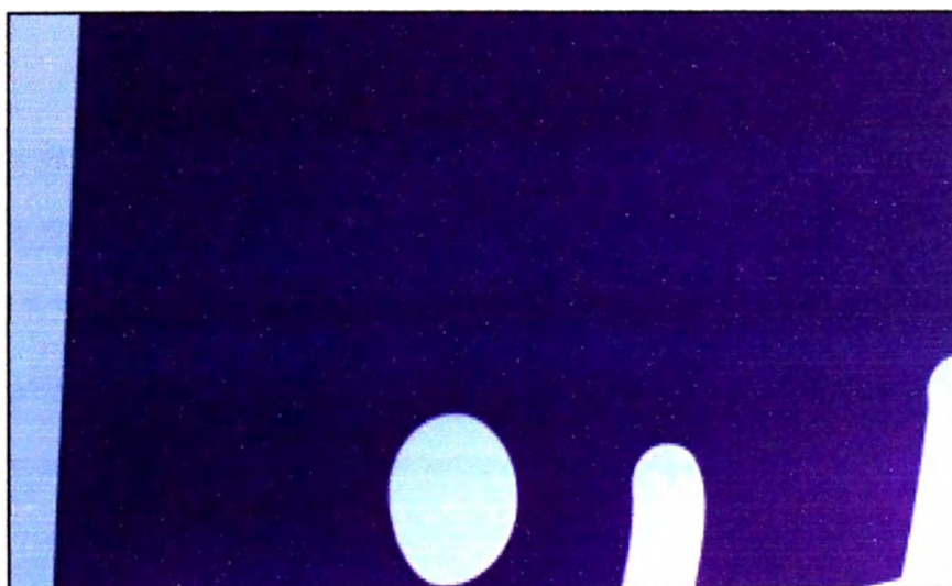
Figura 3.2 Problemas de impresión en tonos sólidos.
