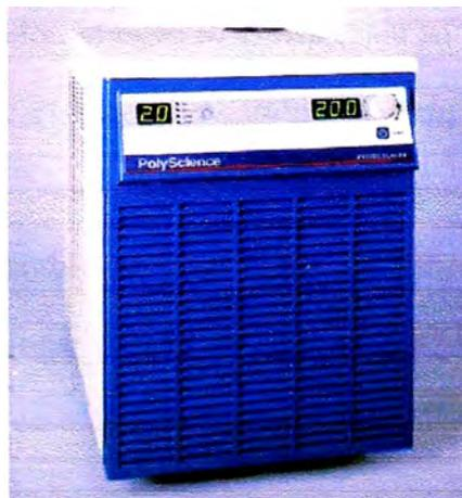
Figura 2.9: Recirculador de agua para aplicaciones de Laboratorio
