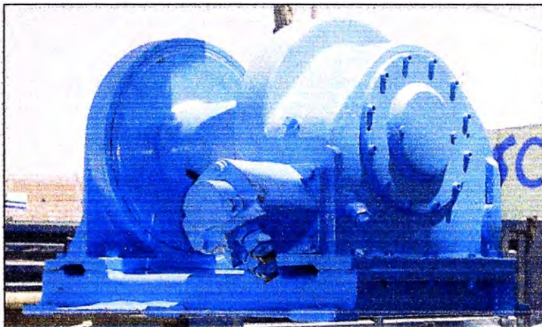
Fig. 2.9 Winche de Tangón modelo IT 6
