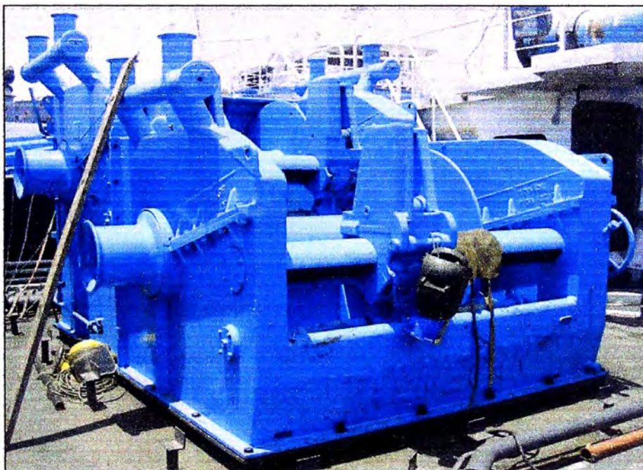
Fig. 2.2 Winche de Combinación modelo IT 35
