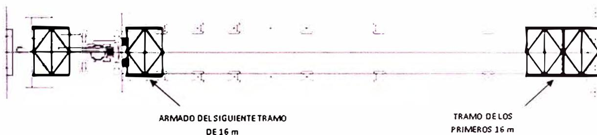
Figura 4.14 VISTA DE PLANTA UBICACIÓN FINAL DEL PRIMER TRAMO VIGA DE RIGIDEZ
