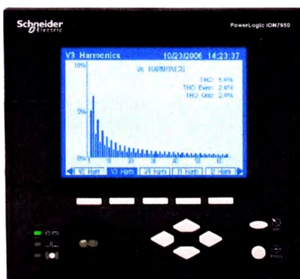
Figura 5.3: Equipo de medición Power Logic Schneider
