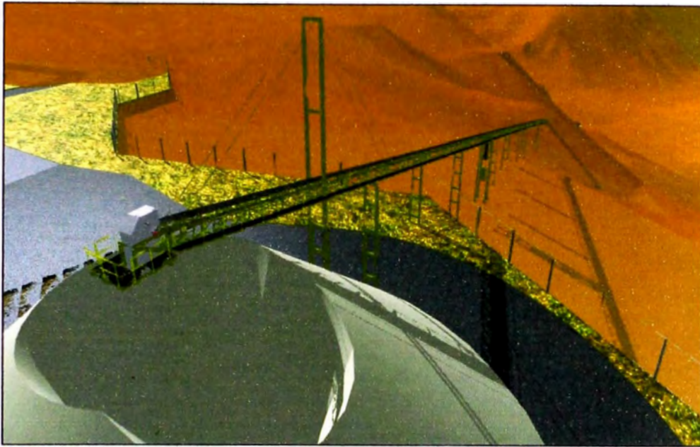
Figura 3.3. Faja desde la torre de transferencia hacia el stockpile.
