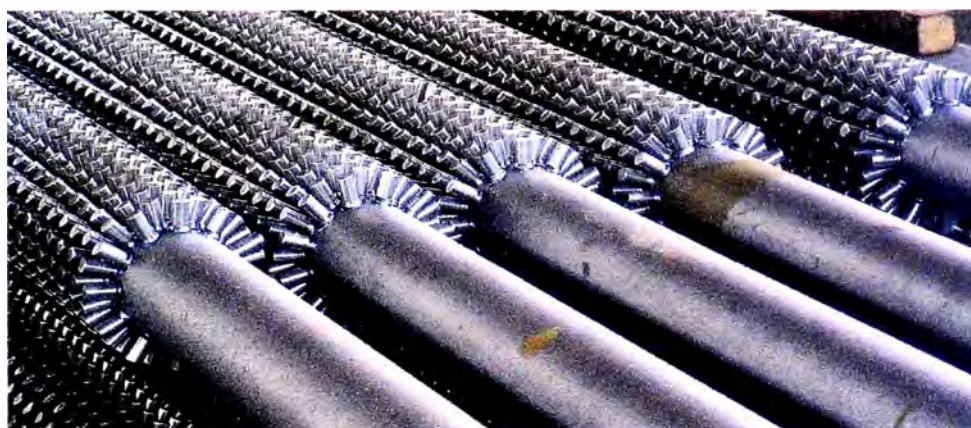
Fig. 4.1. Tubos de Superficie extendida compuesta por pitones o birlos.
