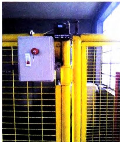
Fig. 6.5. Guarda de seguridad con su sistema de parada de emergencia e interlock.
