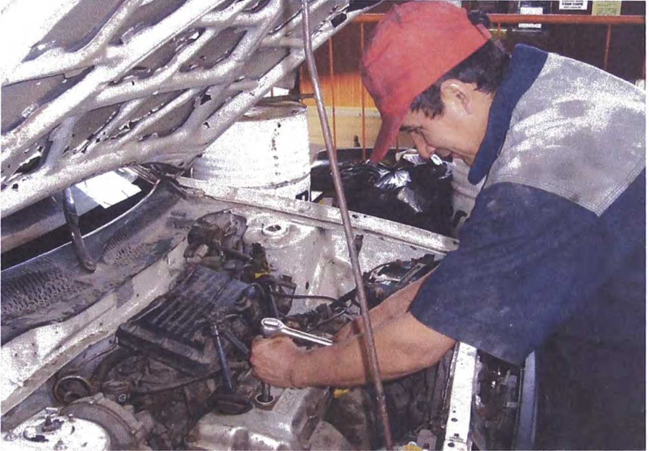
Figura 5.14 MONTAJE SIN EL USO DE LLAVE DINAMOMÉTRICA
