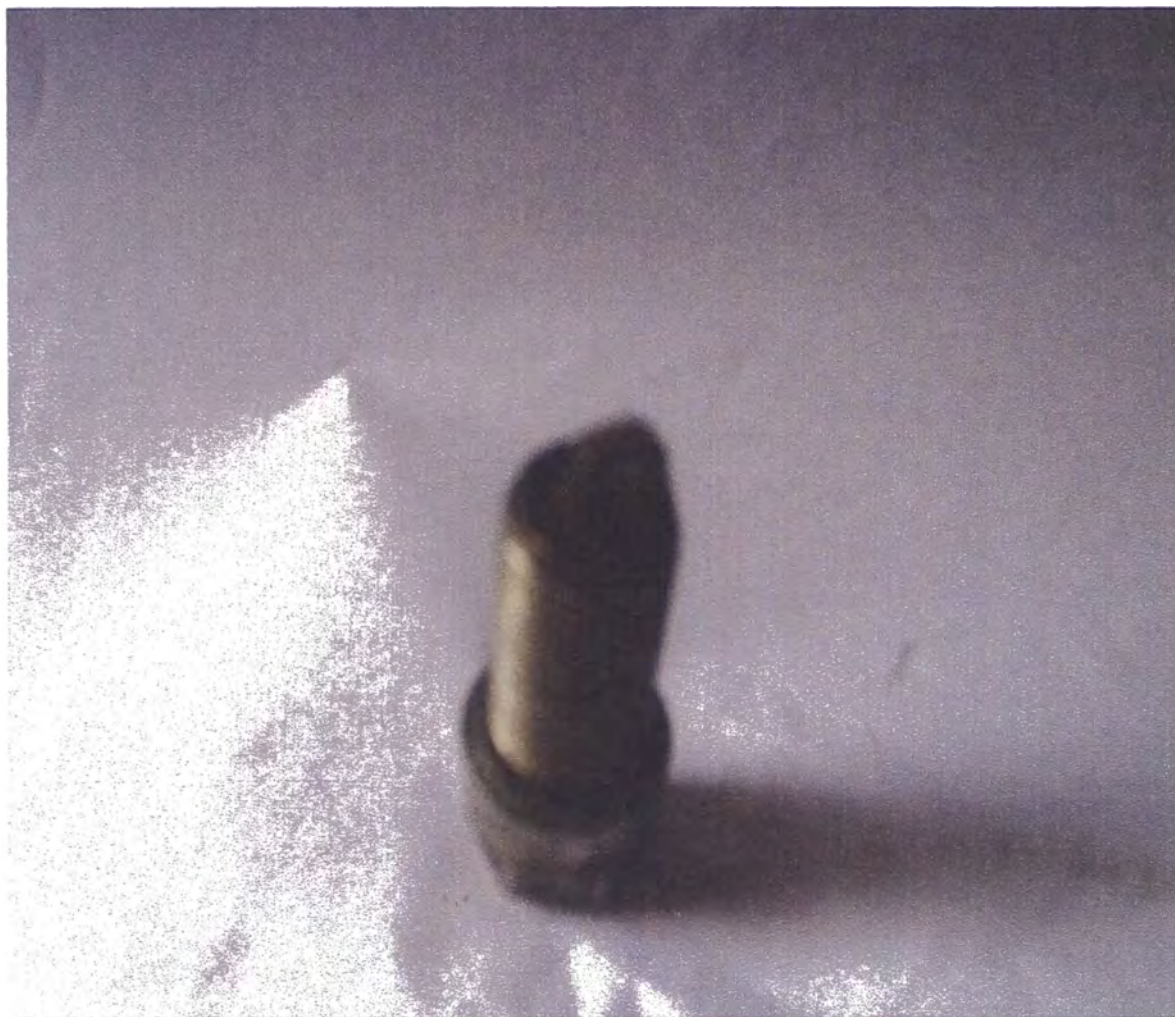
Figura 5.12 BUJÍA CON HOLLIN (Grado térmico BOSCH 8 )
