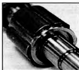
Figura 3.11 ROTOR DE IMANES PERMANENTES
