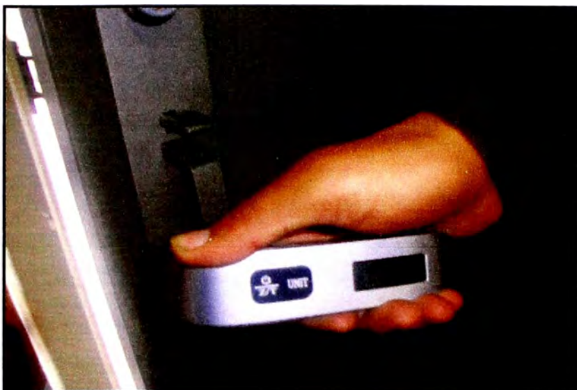
Fig. 3 Valor de la medición de apertura de puerta
