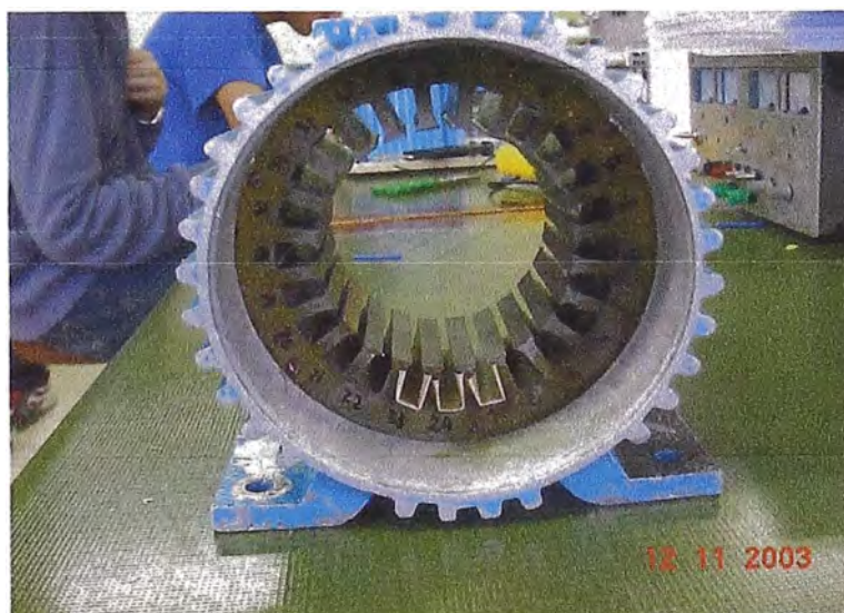
Figura 3.5. Estator de un motor de inducción
