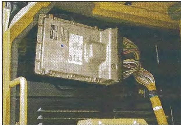
Fig. 2.7 Modulo de Control Electrónico (ECM)
