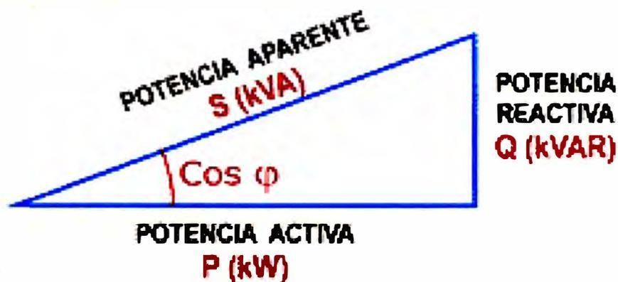
**Figura 4.4. Triángulo Vectorial de Potencias**
