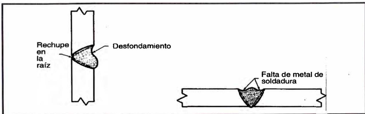
Figura 2.34: Falta de Metal de Soldadura
