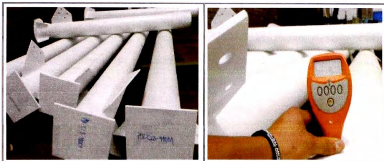
Figura 3.6: Medición de los espesores de Pintura para las Columnas del Tanque
