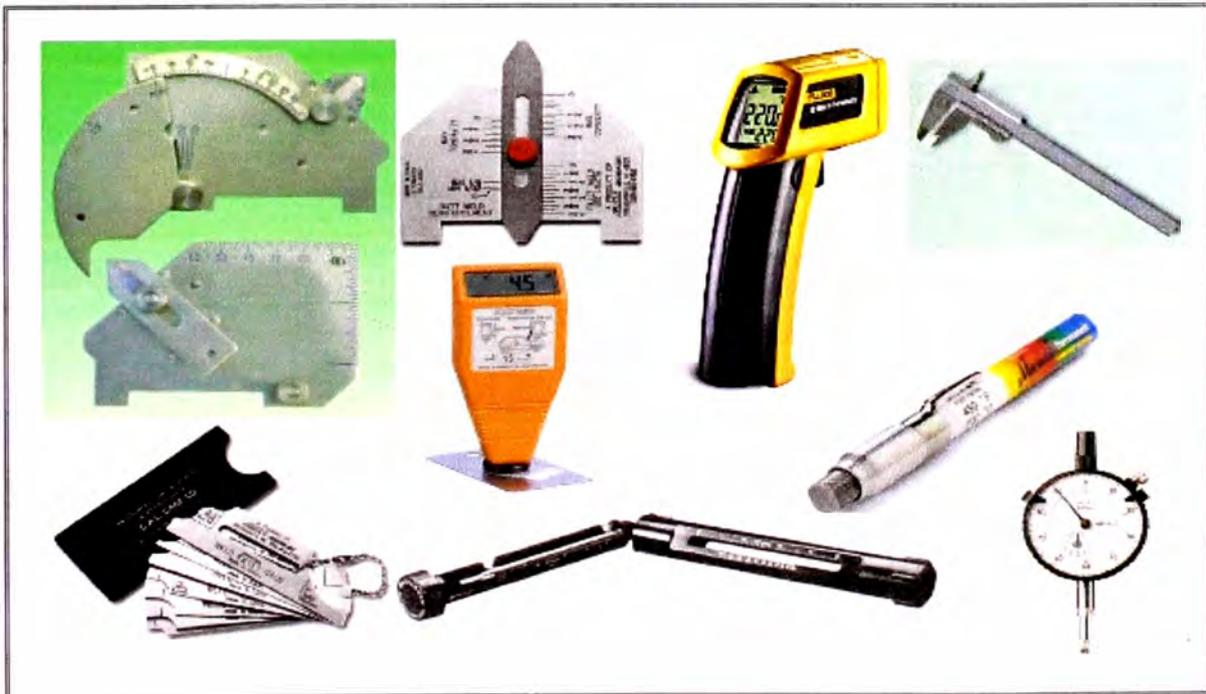
Figura 4.3: Herramientas necesarias para la Inspección Visual
