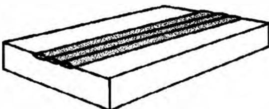
Soldadura efectuada sobre una superficie, en contra posición a la realizada en una unión, para obtener unas dimensiones o propiedades deseadas (en general, aumentar la resistencia al desgaste o a la corrosión).
