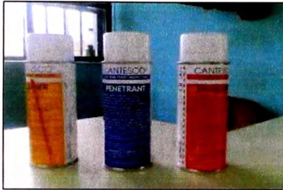
Figura 4.5: Líquidos Penetrantes (Limpiador, Penetrante, Revelador)
