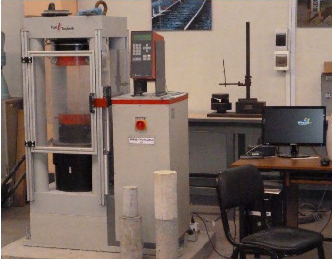
Prensa Hidráulica Toni / Technik Capacidad 300 Tn.
