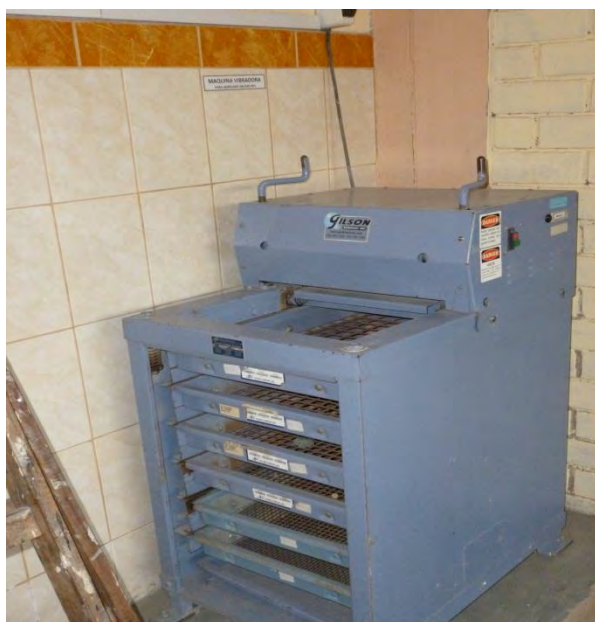
Zaranda Eléctrica de Agregado Grueso
