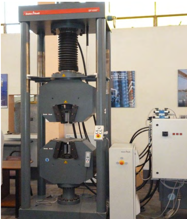
Maquina Universal Zwick/ Roell Capacidad : 100 KN
