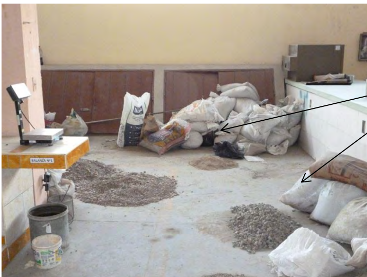
Muestras de Agregados colocadas en zona de transito peatonal
