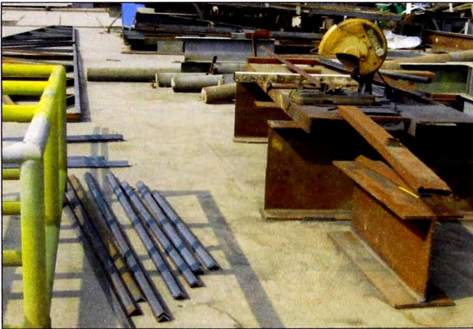
Fig. 3.5 Habilitado de ángulos para los tijerales. Tronzadora Ø14"
