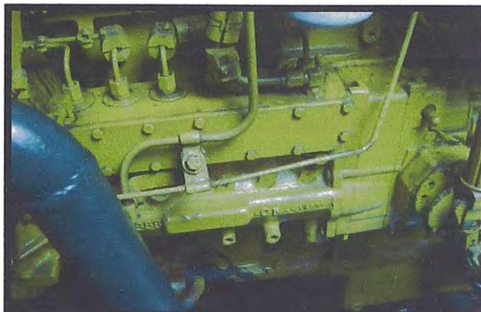
Figura 5.8 Bomba de inyección
