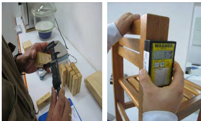
Foto 3: Ensayo de humedad método higrómetro de contacto.
