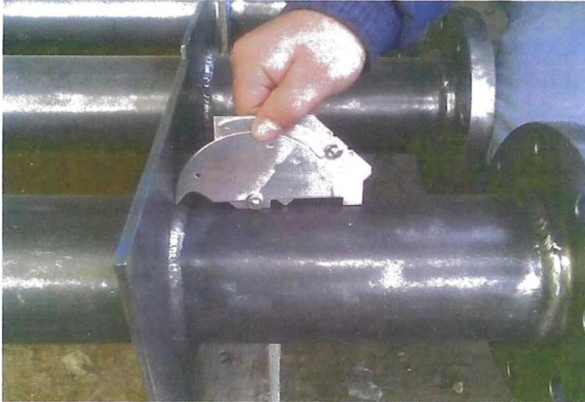
**Figura 3.9 Inspección a juntas soldadas – Filete.**
