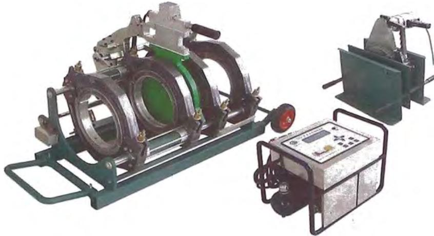
**Figura 3.8 Equipo de termo fusión.**
