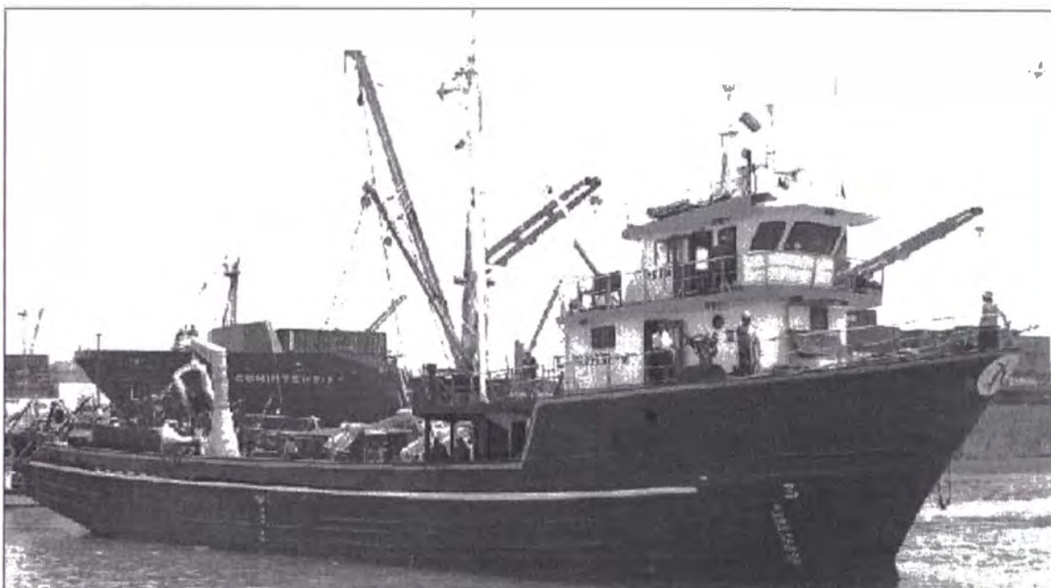
Fotografía N° 1: Corresponde a una embarcación pesquera del tipo de cerco, con capacidad de bodega 350 metros cúbicos y construido en el año 1992
