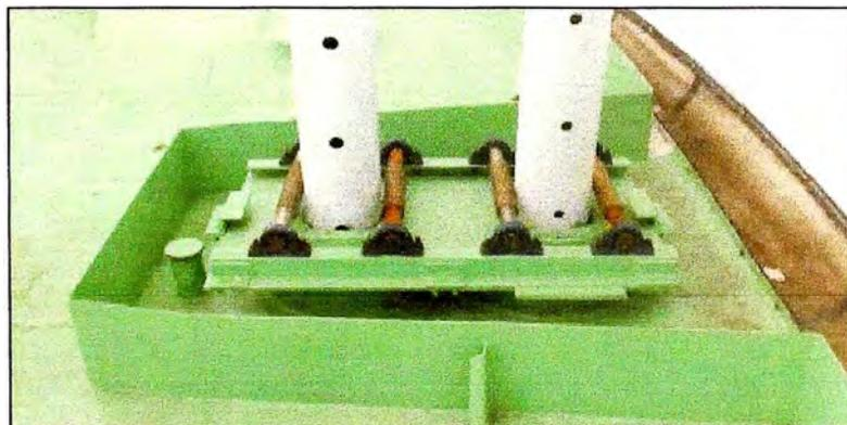
Figura 3.12: Nuevo sistema anti rotacional instalado
