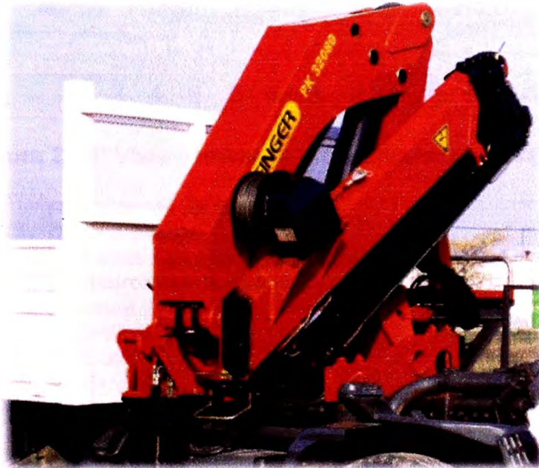
Figura 2.17: Grúa Articulada Palfinger en posición de guardado.
