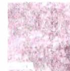
**Grado C** Superficie de acero en donde la capa de laminación ha sido eliminada por la corrosión o la capa de laminación puede ser eliminada por raspado, pero en la cual no se han formado en gran escala cavidades visibles.
