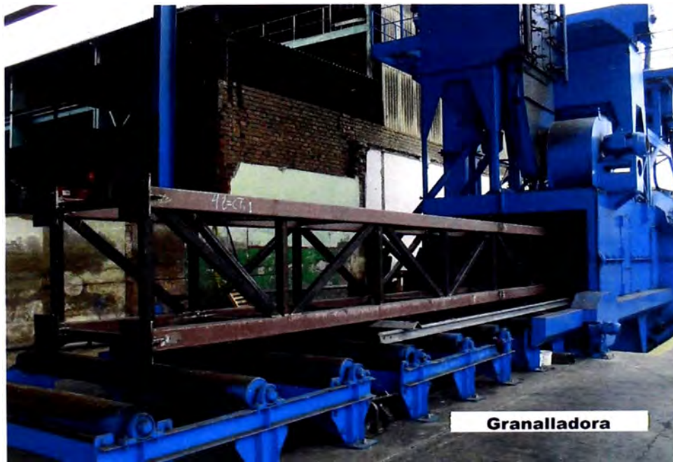
Figura 3.10 Granallado de estructuras (Ingreso)
