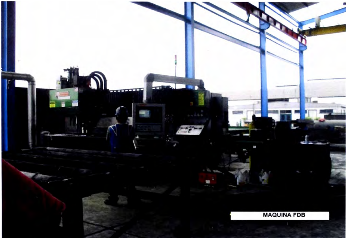
Figura 3.6 Maquina CNC-FDB Perforadora y cortadora de planchas.
