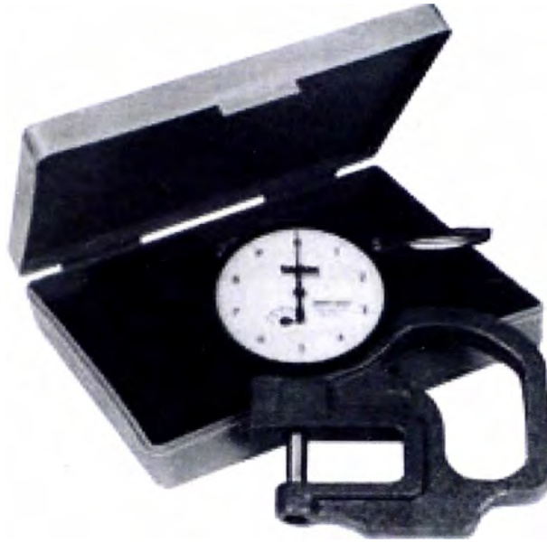
Figura 3.15 Equipo de medición de perfil de anclaje
