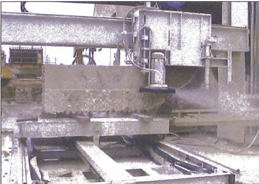
**Figura 2: Máquina Cortadora de Bloques**
