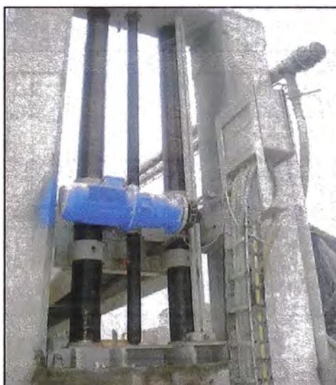
**Figura 47: Sistema de Medida Incremental Magnético, junto al motor del Puente**
