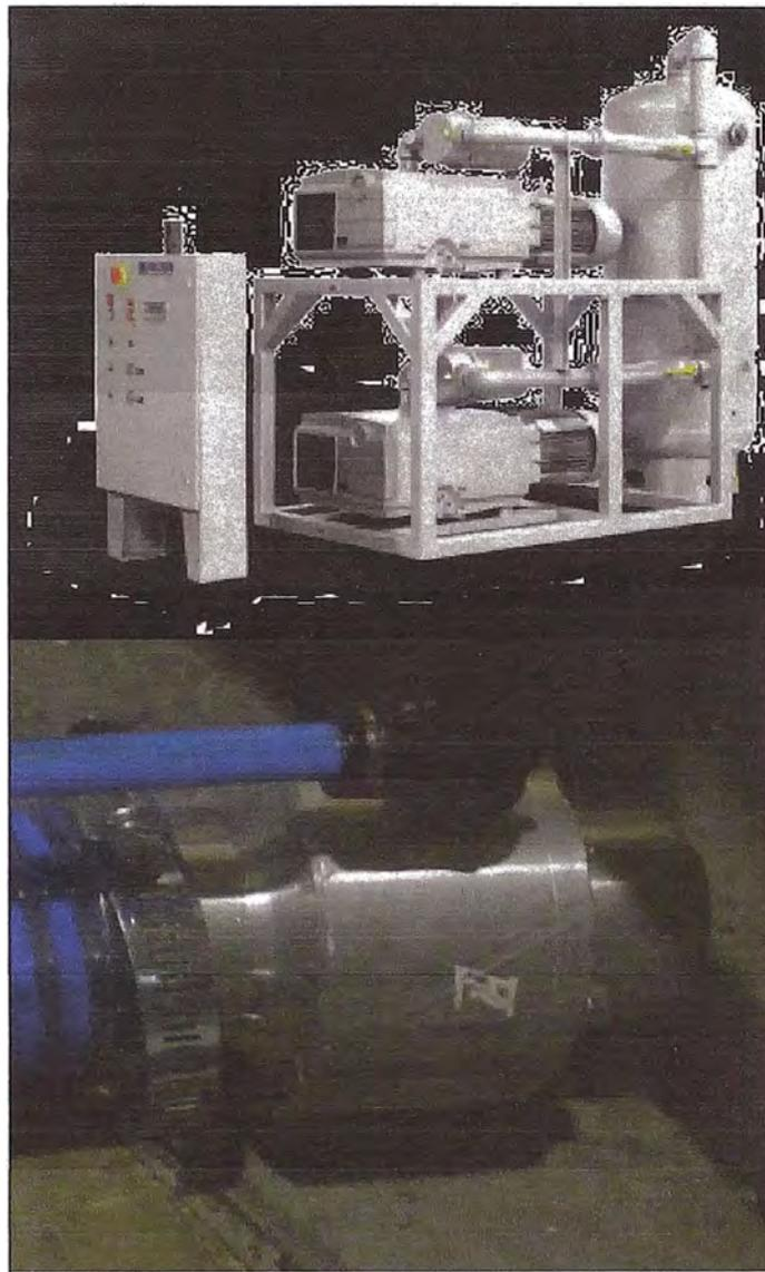
**Figura 1.5.** Bomba de vacío (arriba) y succionador de aire (abajo)
