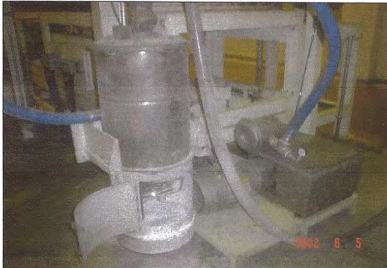
**Figura 5.3.** Bomba de vacío Busch y Granulador Colortronic.
