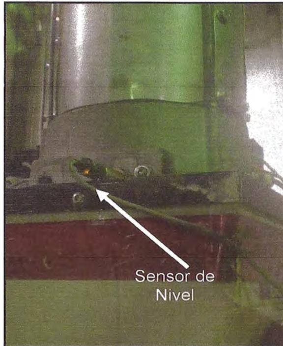
**Figura 5.5.** Sensor para detección de estado de la tolva (lleno o vacío).
