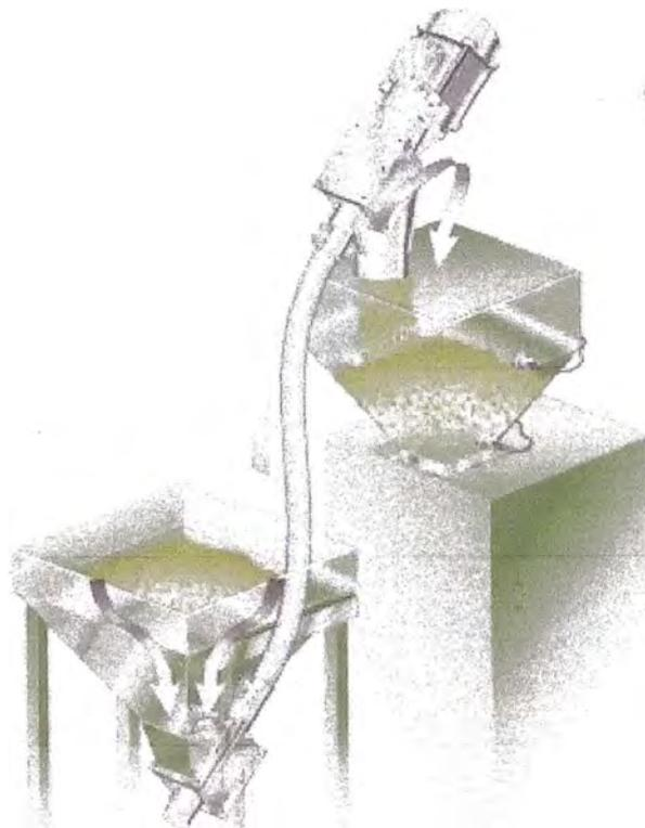
**Figura 3.8.** Tornillo de dosificación.
