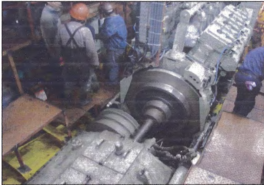
Fig. 2.2 Montaje de motores marinos
