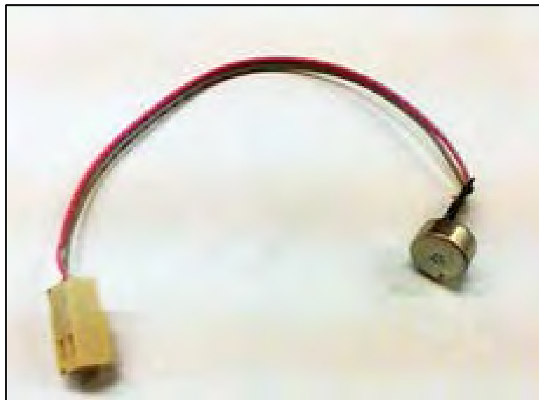
Figura D.4 Fotografía del micrófono electret
