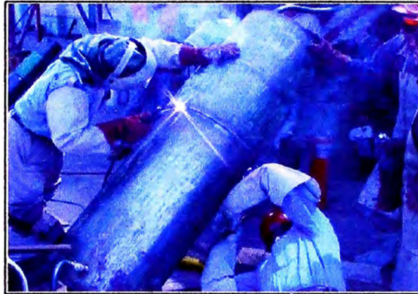
Figura 2.1 Calificación de un procedimiento de soldadura según ASME IX
