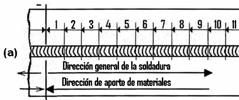
Figura 2.50a: secuencia de soldadura (2).
