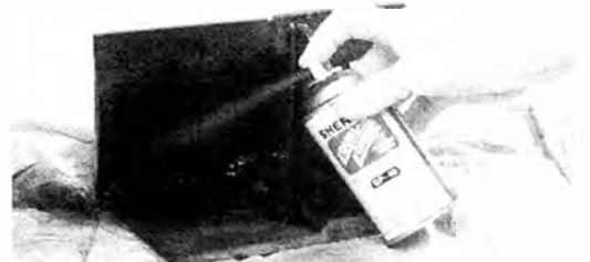
Penetrante sobre la Superficie de Ensayo y en la Fisura
