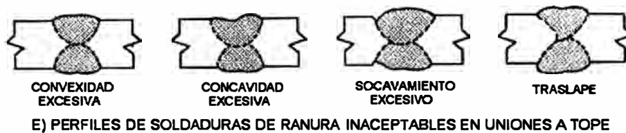
Figura 2.57: perfiles de soldadura aceptable e inaceptable
