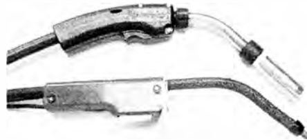
Figura 2.17 - Pistolas FCAW para Electrodos con Protección Gaseosa (arriba) y Auto protegidos (abajo).
