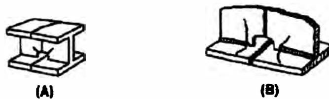
Figura 2.2: fabricación de perfiles tipo H
