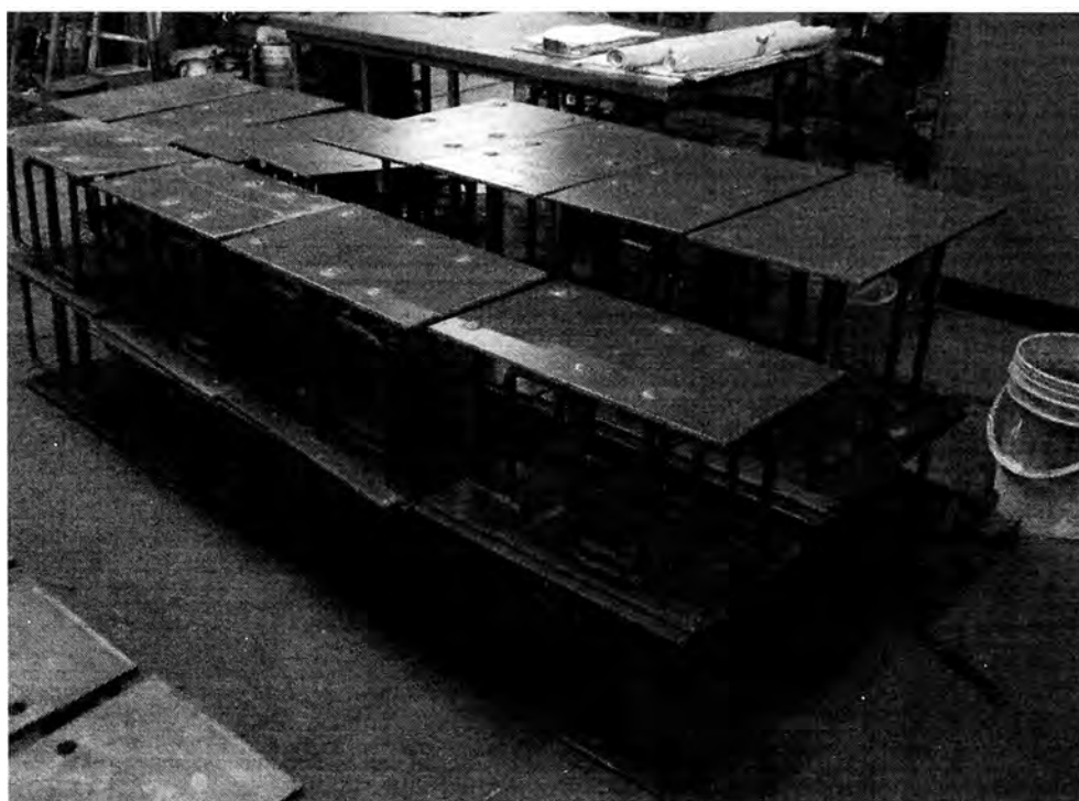
Figura 3.21: Plancha de anclaje
