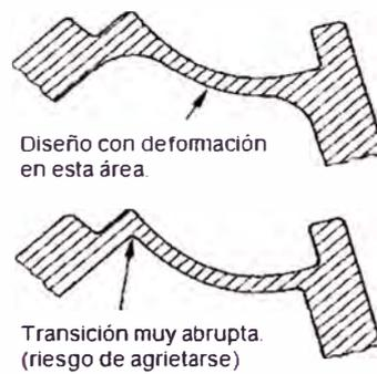
**Fig. 4.3 Consideración de diseño de la bisagra**
