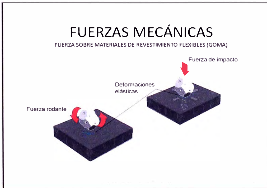
Fig. 2.24: Efecto de las Fuerzas mecánicas en elementos de goma
