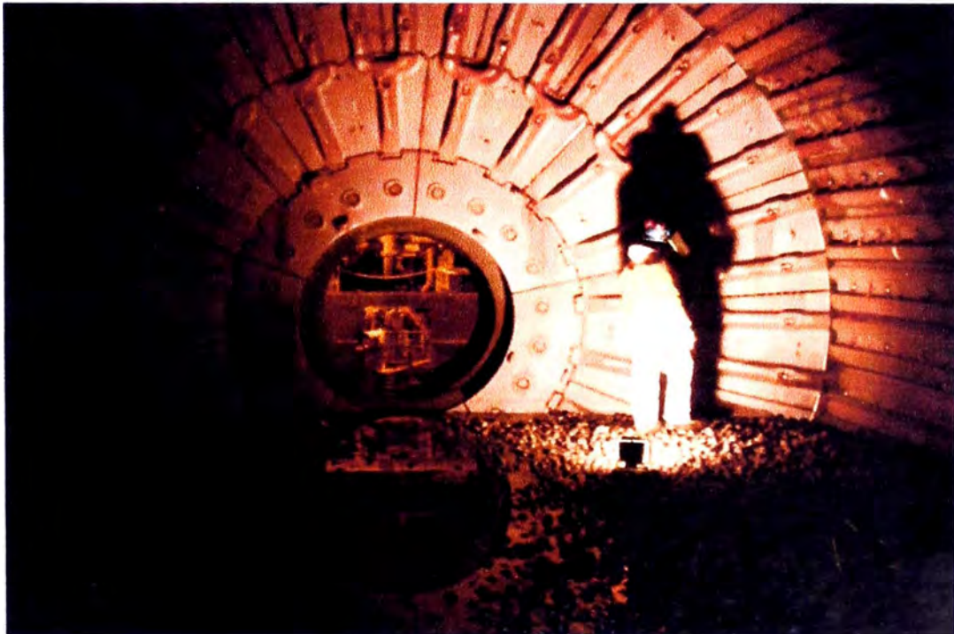
Fig. 3.2: MOLINO DE BOLAS 24'X35.5'-ANTAMINA (Quiebre de revestimiento de la tapa de alimentación)
